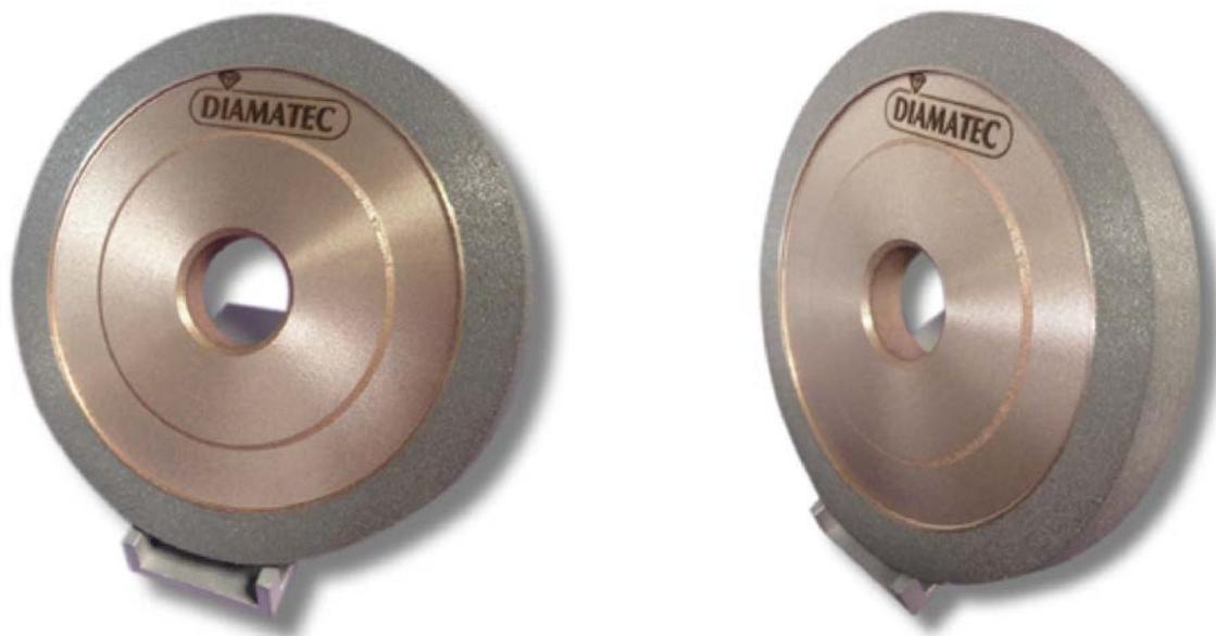
L'avantage des meules diamant ou CBN vitrifiées réside dans le procédé de fabrication qui permet de contrôler, dans une certaine mesure, la porosité de la couche abrasive. Cette porosité permet d'avoir des espaces vides entre les grains pour limiter la surface de contact avec la matière, diminuer l'effort de coupe et maximiser la circulation du liquide d'arrosage pendant le travail.
